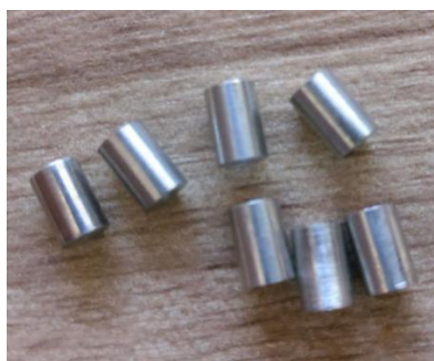
Figura 3.3 - Cilindros das ligas Sn-Bi e SnBi-In para os ensaios de molhamento.
