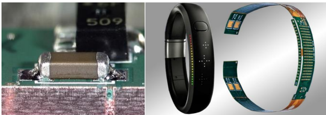
Figura 2.1 - (a) Dispositivo de montagem de superfície montado com pasta de solda livre de chumbo e (b) Aplicação em circuito flexível de um rastreador fitness [22].
