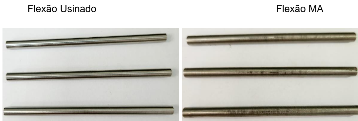
Figura 15 – Amostras para ensaio de flexão prontas
