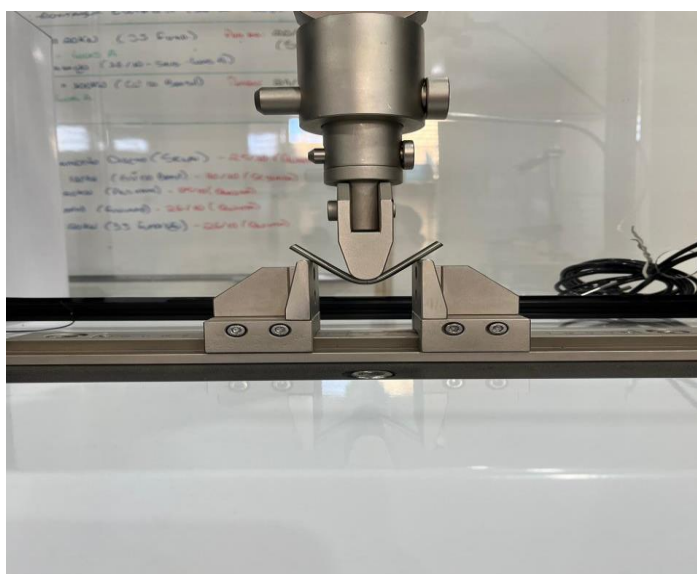
Figura 22 – Corpo de prova em curvatura durante teste de flexão
