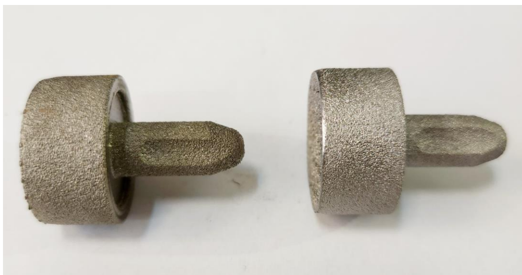
Figura 11 – Prótese produzida pelo processo de manufatura aditiva
