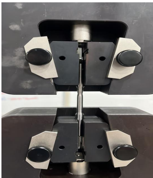
Figura 18 – Início do empescoçamento do teste de tração
