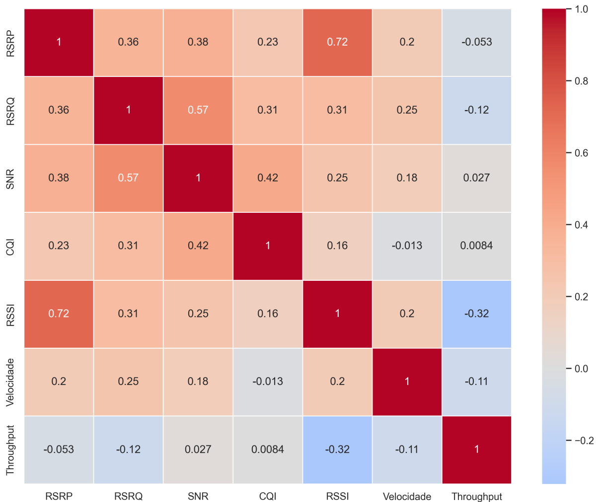
Figura 19 – Correlação de Pearson calculada para todo o conjunto de dados (condições estáticas e em condução), abrangendo métricas de canal.
