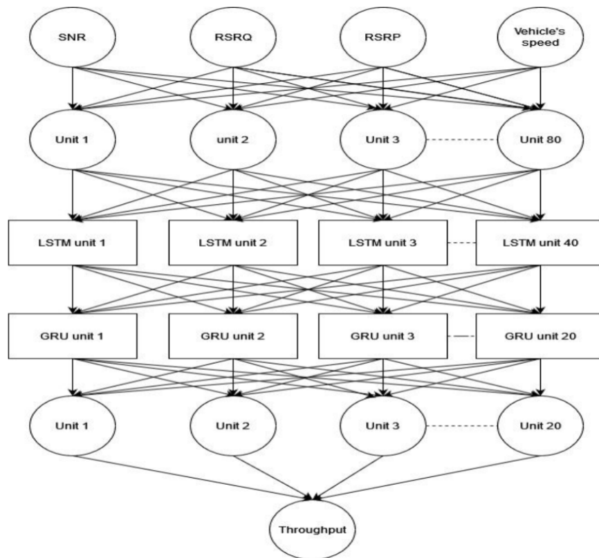
Figura 16 – Estrutura do modelo híbrido LSTM–GRU proposto.
