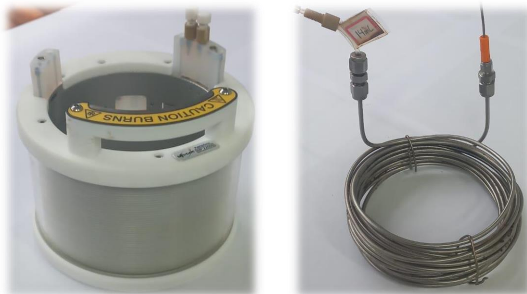
(A) (B) FIGURA 1.7: Reatores tubulares (A) de PFA (Syrris) e (B) aço inoxidável (LQBO).
