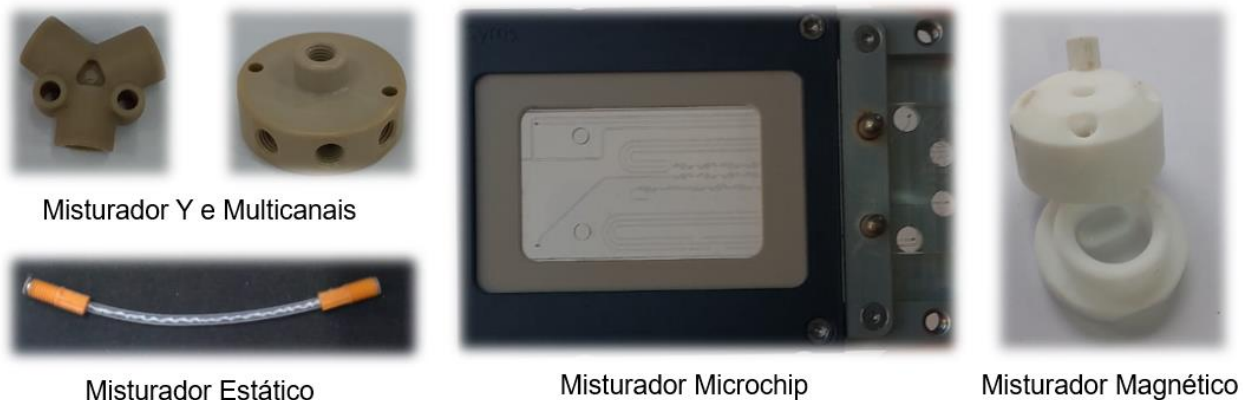
FIGURA 1.5: Misturadores do tipo Y e fluxo cruzado multicanais, estático, microchip e com agitação magnética.
