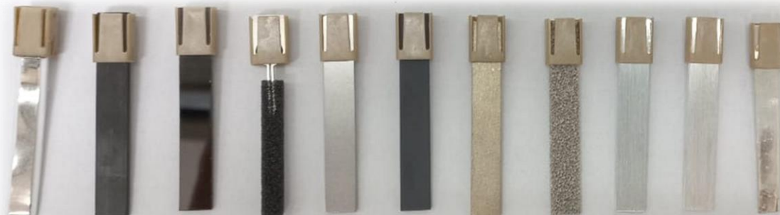
FIGURA 1.15: Da esquerda para direita: Eletrodos de folha de platina, grafite, carbono vítreo, carbono vítreo reticulado, aço inoxidável, boro dopado com diamante, níquel, espuma de níquel, zinco, magnésio e eletrodo de prata (sacrifício).
