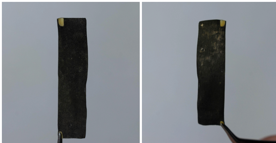
Figura 4.29. Resultado da deposição para a membrana que foi previamente lixada.
