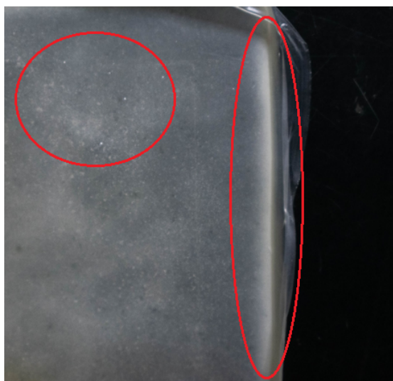
Figura 4.16. Imagem ampliada das regiões com acúmulo da carga de CNC no filme de sSBS120 contendo 5% de CNC.
