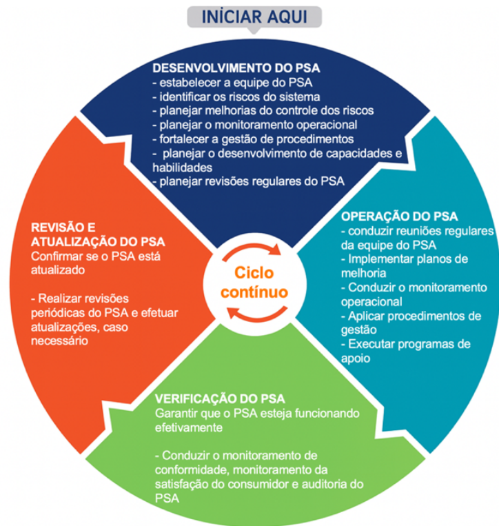
Figura 3 – Etapas metodológicas do plano de segurança da água e seu ciclo contínuo
