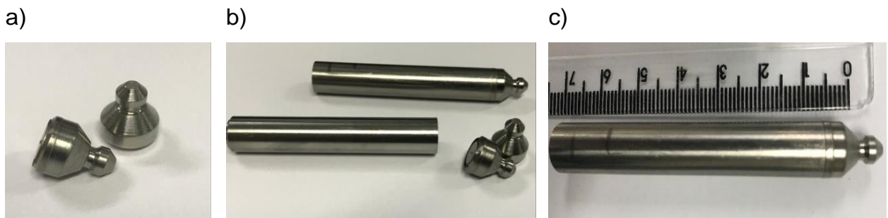
Figura 23 – a) Tampões terminais, b) Tubo, tampões terminais e corpo de prova e c) Corpo de prova
