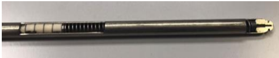
Figura 9 – Detalhes do pleno e região do tampão terminal das varetas
