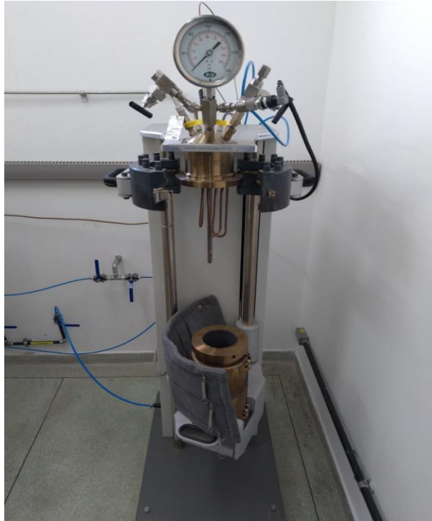
Figura 24 – Autoclave utilizado para os testes de corrosão
