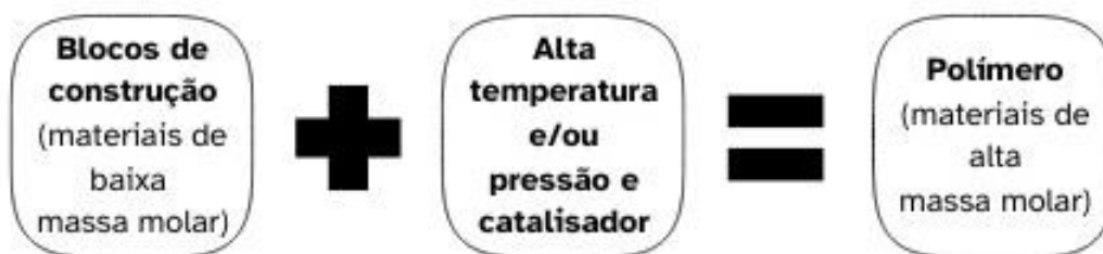
Figura 1 - Representação geral da reação de polimerização.
