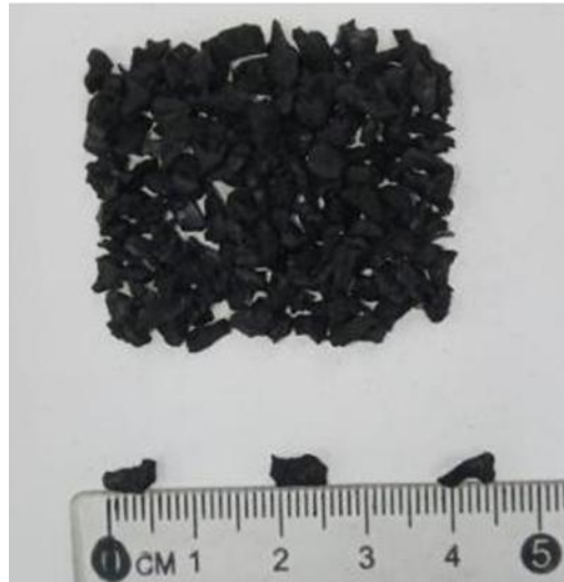
Figura 3 – Pneu triturado utilizado como meio suporte
