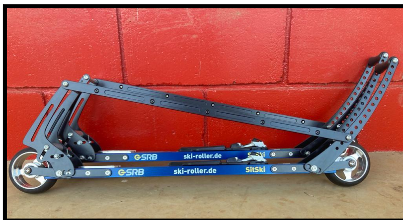
Figura 15: Rollerski sit-ski com sistema de freio
