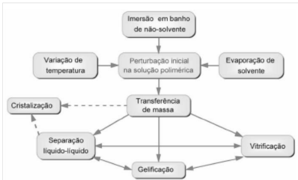
FIGURA 1.3.1 - Processos envolvidos na formação de membranas por inversão de fase (HABERT et al. 26).
