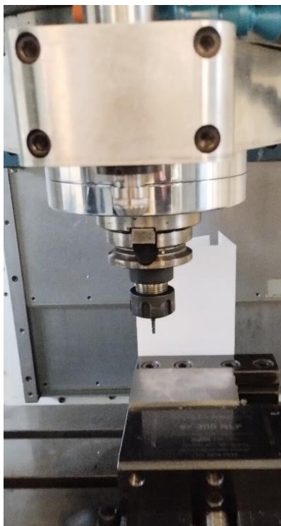
Figura 13. Esquema de fixação da ferramenta e do corpo de prova.
