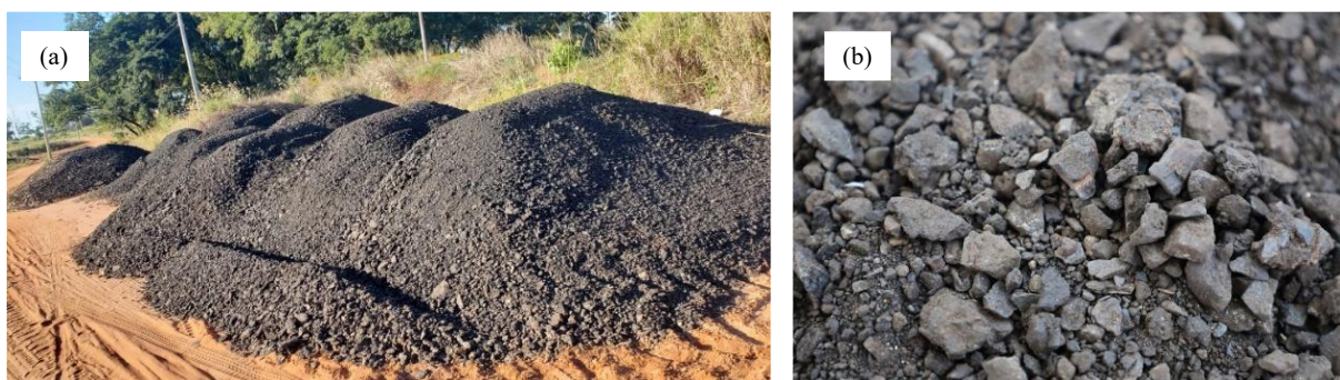
Figura 3.1. Aspecto do RAP coletado: (a) pilha de RAP local; (b) agregados do RAP.
