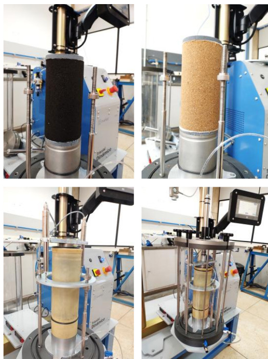
Figura 3.9. Montagem de ensaio cíclico da areia reciclada de RAP e da areia natural no Laboratório de Geotecnia da UFSCar.
