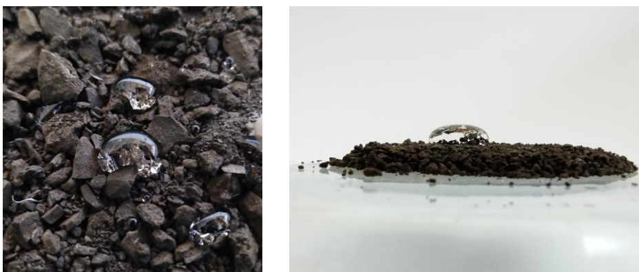
Figura 4.24. Comportamento de repelência de água da areia reciclada de RAP com a água.
