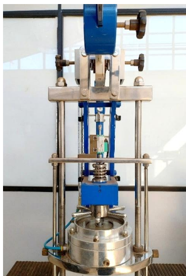
Figura 3.6. Equipamento de compressão edométrica utilizado na pesquisa do Laboratório de Geotecnia da UFSCar.
