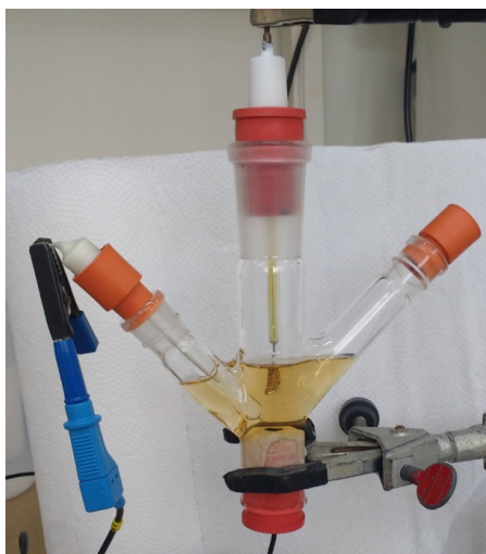
FIGURA 3.4 – Célula eletroquímica de 3 eletrodos montada para deposição do filme da liga \text{CoFe}_2 .
