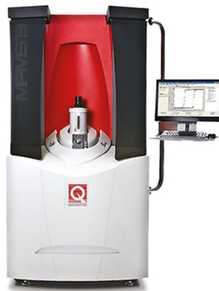
FIGURA 3.9 – Sistema de medidas de propriedades magnéticas com sonda SQUID.
