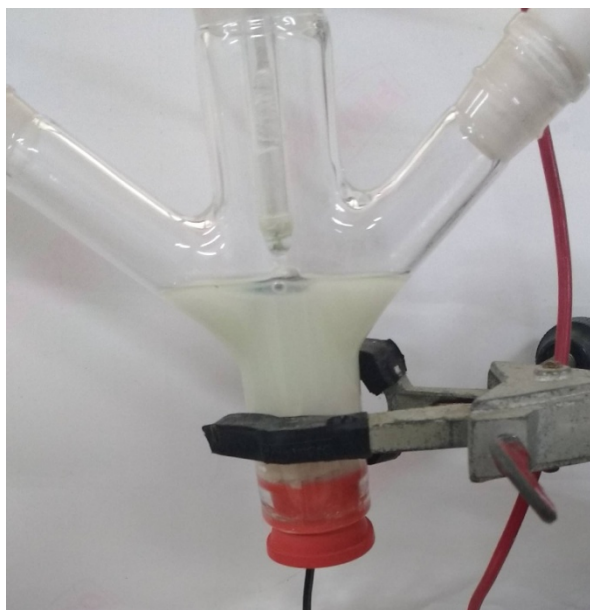
FIGURA 3.6 - Célula eletroquímica de 2 eletrodos montada para deposição eletroforética do filme cerâmico de PZT.
