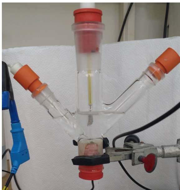
FIGURA 3.5 - Célula eletroquímica de 3 eletrodos montada para crescimento do filme cerâmico \text{CoFe}_2\text{O}_4 .
