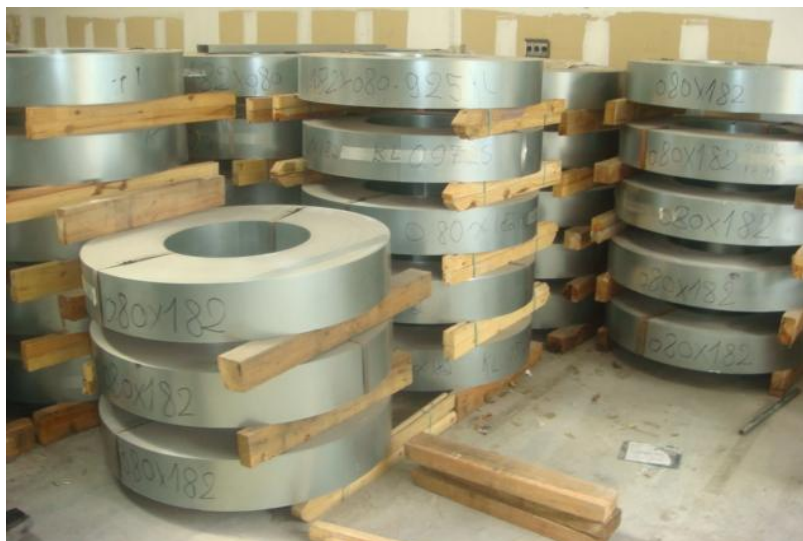
Figura 37 - Estoque de bobinas galvanizadas, com corte longitudinal realizado.
