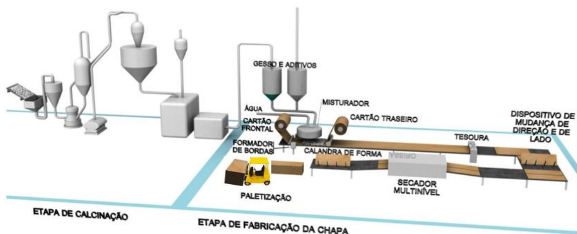
Figura 47 - Processo de produção das chapas de gesso acartonado
