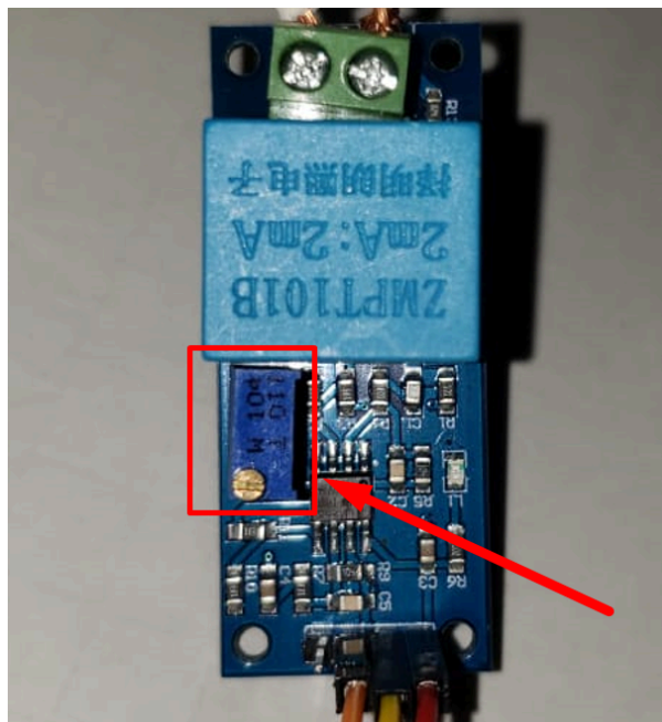
Figura 27: Identificação do potenciômetro do sensor de tensão para calibração.
