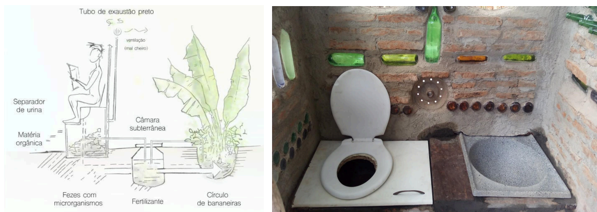
Figura 2 - Estrutura e funcionamento do Banheiro seco
