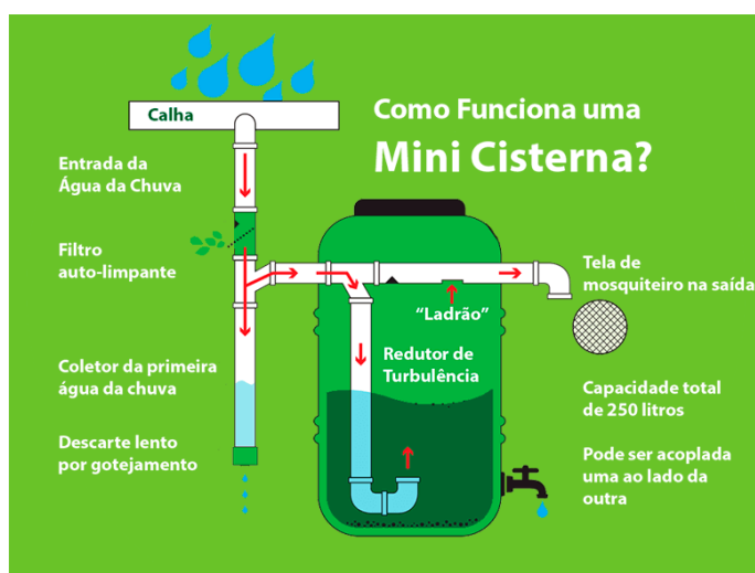
Figura 10 - Estrutura da Mini-cisternas
