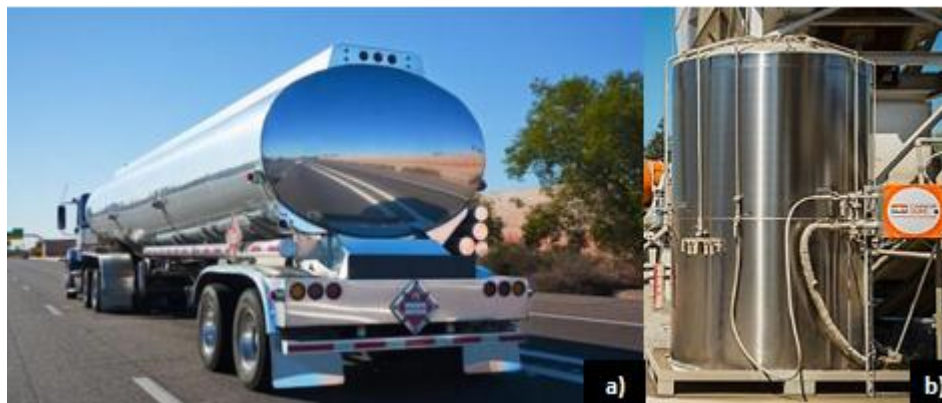
Figura 18 - Armazenamento do CO 2 : a) no transporte, após coleta das chaminés das indústrias e posterior purificação; b) nos tanques da empresa que utiliza a tecnologia da captura e armazenamento de CO 2 em seus concretos
