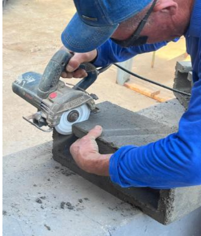
Figura 119 - Amostras sendo cortadas da região superior do bloco.
