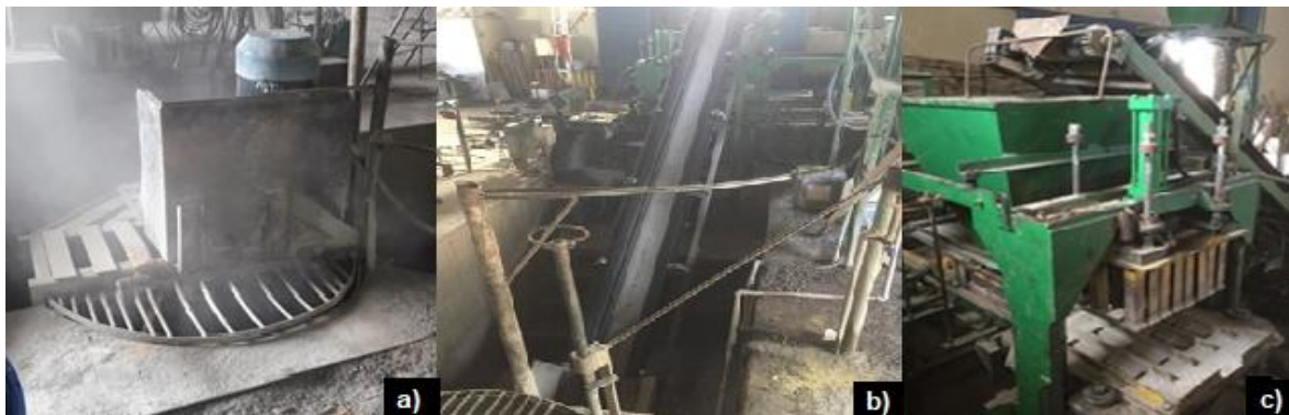
Figura 104 - Equipamentos empregados na fabricação dos blocos: a) misturador, b) esteira, c) máquina vibroprensa.
