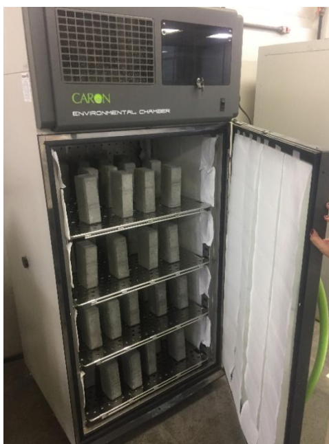
Figura 53 - Ensaio de ganho de massa realizado em peças de concreto para pavimentação
