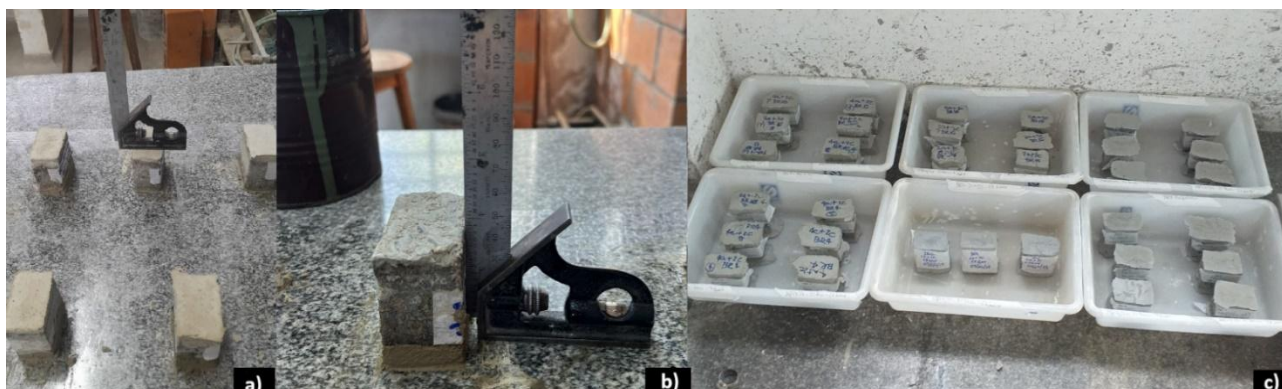
Figura 125 - Capeamento das amostras: a) nivelamento, b) nivelamento, c) amostras capeadas e identificadas.
