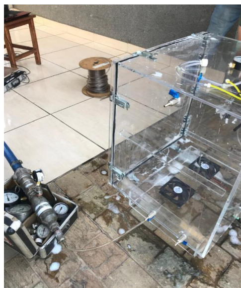
Figura 69 - Teste de estanqueidade.
