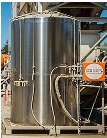
Figura 50 - Tanque para armazenamento de \text{CO}_2 capturado
