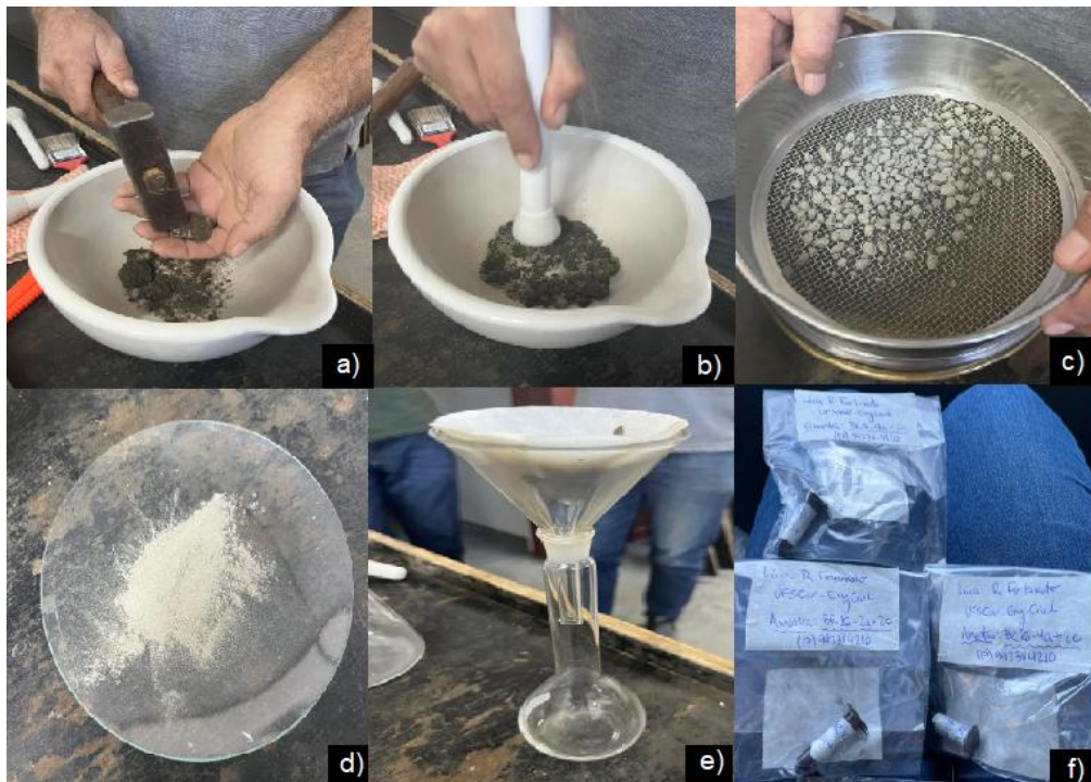
Figura 124 - Preparação da amostra no Laboratório de Materiais e Componentes da UFSCar (LMC): a) trituração; b) maceração; c) peneiramento; d) amostra pulverolenta; e) filtragem em álcool isopropílico; e) armazenamento em eppendorf.
