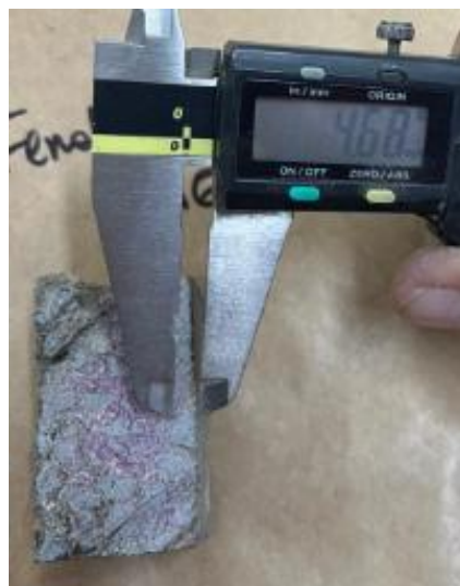
Figura 149 - Mensuração do avanço da frente de carbonatação na amostra BR 16 – 3a+8c.
