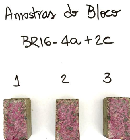
Figura 157 - Amostras dos blocos BR 16 - 4a+2c, após aspersão de fenolftaleína.
