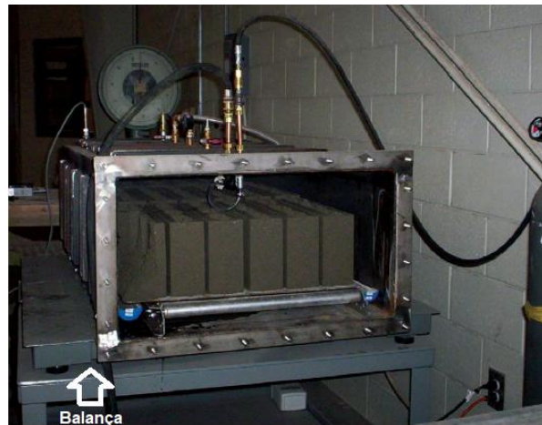
Figura 54 - Quantificação da captura de CO 2 em blocos de concreto, através do método da curva de massa
