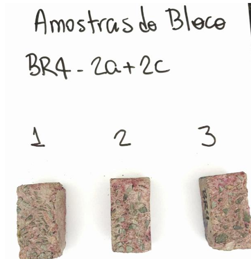
Figura 156 - Amostras dos blocos BR 4 - 2a+2c, após aspersão de fenolftaleína.
