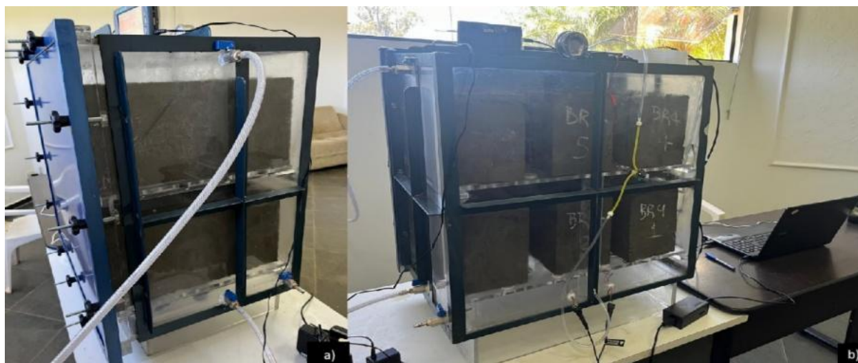
Figura 128 - Cura dos blocos de concreto com CO 2 .
