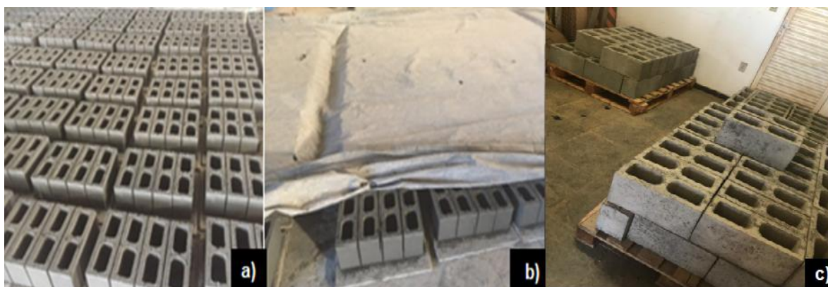
Figura 105 : Blocos de concreto: a) distribuídos no barracão, b) cobertos com lona, c) armazenados em sala isolada.
