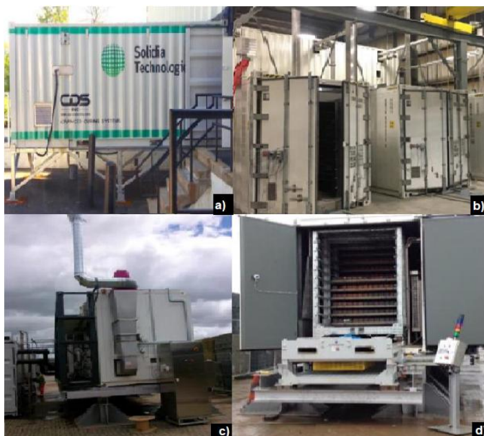
Figura 83 - Câmaras de carbonatação desenvolvidas pela Solidia Technologies em estruturas de Container, localizadas: a) EUA, b) Canadá, c) d) Reino Unido.
