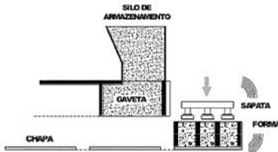
Figura 46 - Etapa de Vibro - compressão
