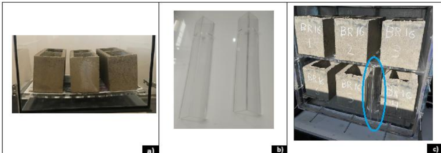
Figura 68 - Prateleiras: a) Empenadas, b) Solução encontrada: calços, c) Prateleiras suportando o peso dos blocos com a inserção dos calços.
