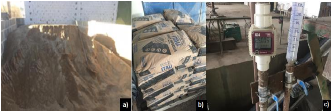
Figura 103 - Matérias – primas: a) baia de agregados naturais, b) cimento ensacado, c) dispositivos de controle de água e aditivo.
