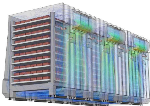
Figura 85 - Fluxo de gás dentro das câmaras Solidia modelado para condições ideais.
