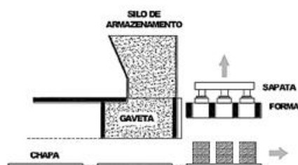
Figura 47 - Subida da forma concomitantemente à subida da sapata e liberação dos blocos
