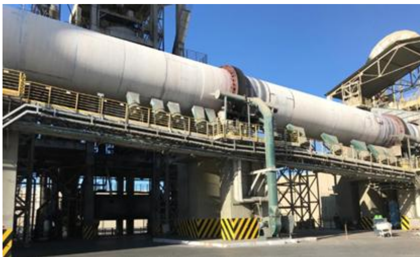
Figura 19 - Forno para produção à seco do clínquer
