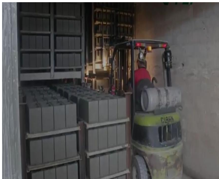
Figura 99 - Câmara de cura à vapor existente em indústria fabricante de blocos de concreto no estado de São Paulo.
