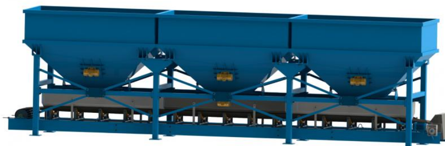
Figura 31 - Usina dosadora de agregados
