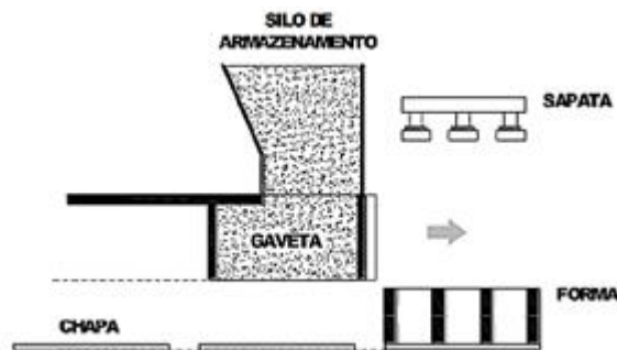
Figura 43 - Posicionamento da forma e avanço da gaveta
