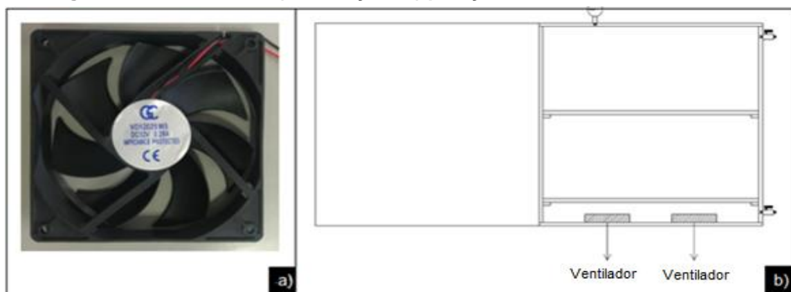
Figura 59 - Ventilador: a) Descrição; b) posição dos ventiladores na câmara.
