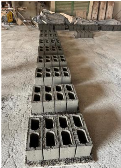
Figura 117 - Blocos sendo curados em galpão coberto da indústria.
