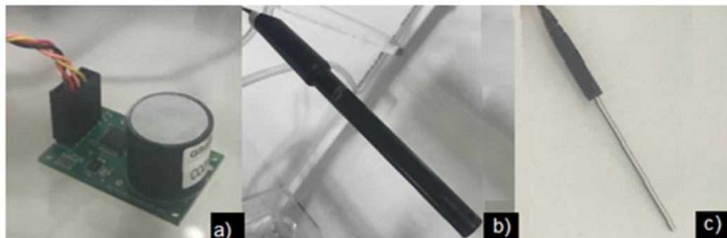
Figura 61 - Sensores: a) Concentração de \text{CO}_2 ; b) Umidade; c) Temperatura.
