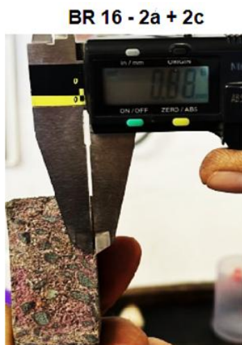
Figura 138 - Mensuração do avanço da frente de carbonatação na amostra BR 16.
