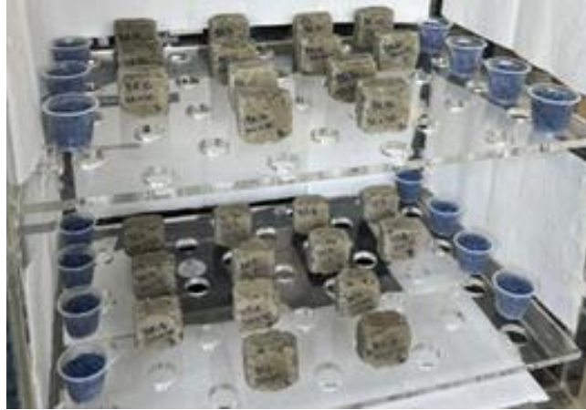
Figura 62 - Sílica gel distribuída no interior da câmara.
