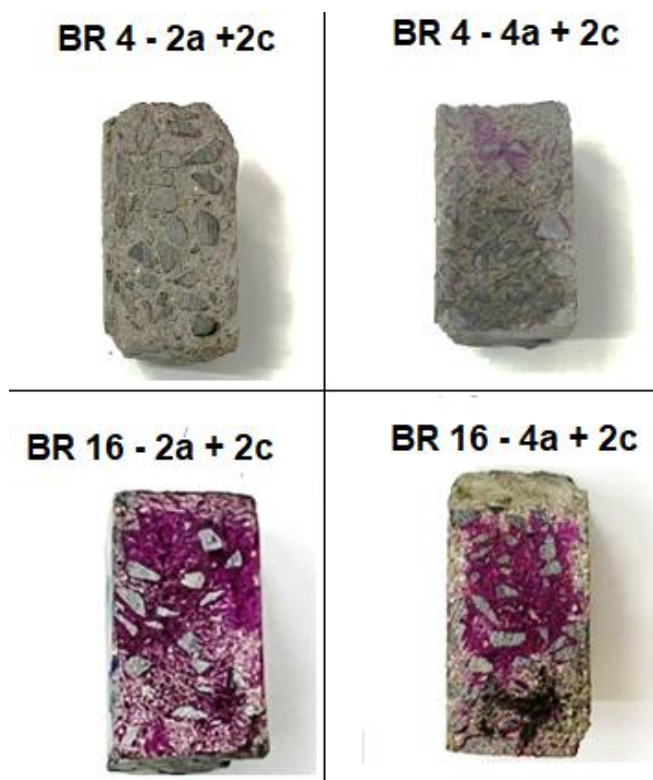
Figura 122 -Verificação da frente de carbonatação com fenolftaleína após 2 e 4 horas de cura carbônica nas amostras dos blocos BR 4 e 16.
