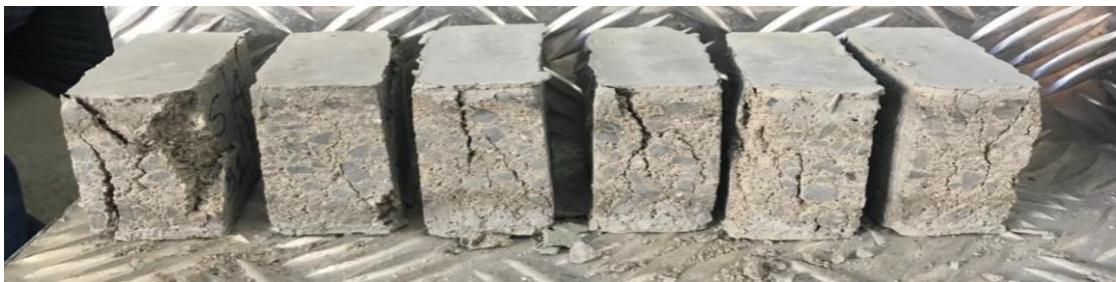
Figura 135 - Ruptura das amostras dos blocos BR 4.
