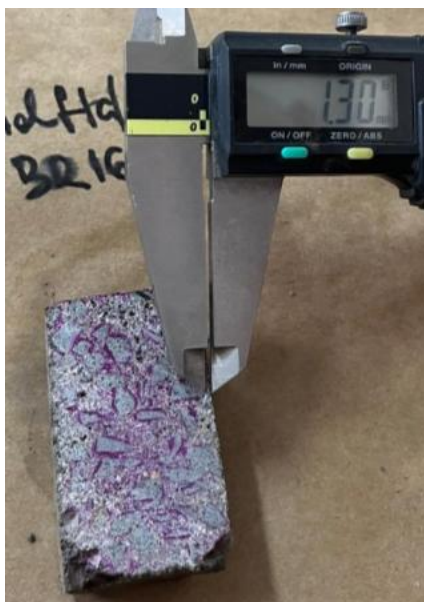
Figura 152 - Mensuração do avanço da frente de carbonatação na amostra BR 16 – 3a+16c.
