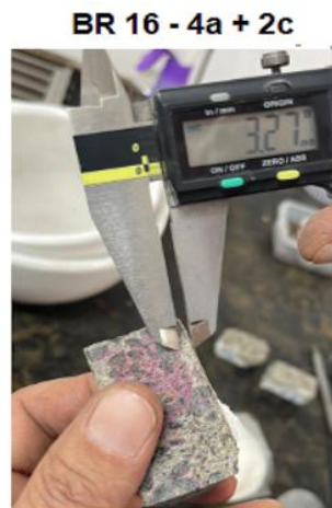
Figura 142 - Mensuração do avanço da frente de carbonatação na amostra BR 16.
