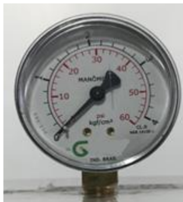
Figura 63 - Manômetro para controle da pressão no interior da câmara.
