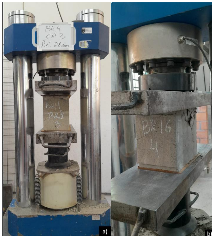
Figura 131 - Ensaio com o bloco e meio bloco na prensa hidráulica.
