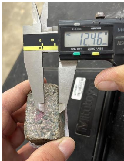
Figura 146 - Mensuração do avanço da frente de carbonatação na amostra BR 16 – 3a+4c.
