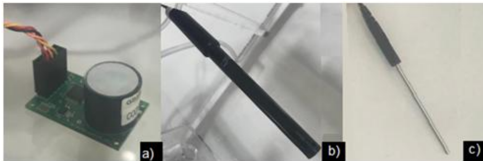
Figura 95 - Sensores: a) Concentração de CO 2 ; b) Umidade; c) Temperatura.
