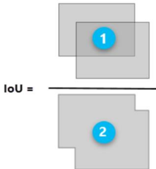
Figura 10 – Cálculo da sobreposição dos objetos pelo índice IoU.
