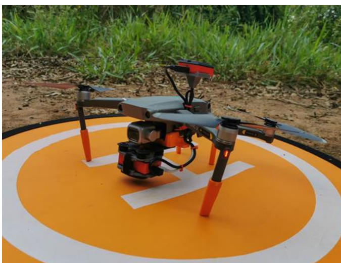
Figura 3 - DJI Mavic 2 Pro adaptado com sensor MSP Parrot Sequoia+ .
