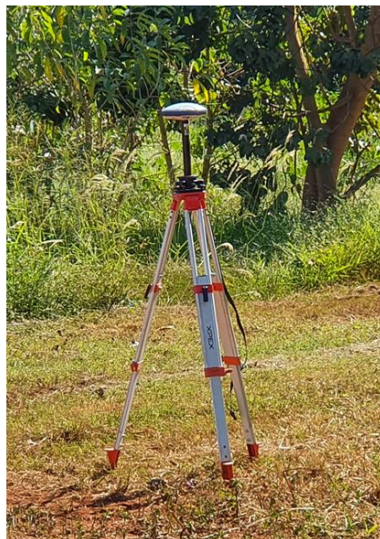
Figura 5 - Coleta do ponto base com o receptor Spectra Precision SP60.
