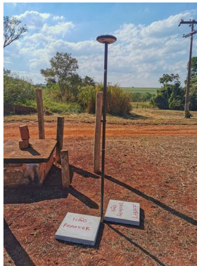
Figura 4 - Coleta dos GCPs com o receptor Spectra Precision SP60.
