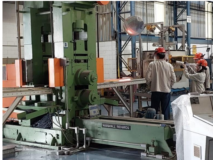
Figura 4.2 - Laminador duo reversível utilizado na laminação das cunhas.
