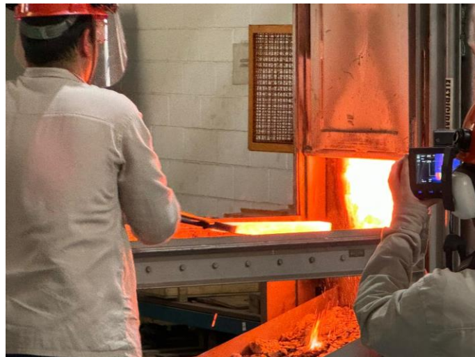
Figura 4.3 - Desenformamento das cunhas para laminação.
