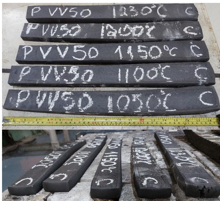
Figura 5.22 - Cunhas após a laminação nas 5 temperaturas definidas.
