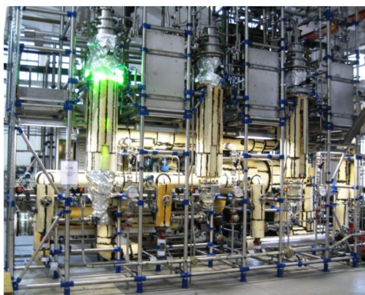
ESQUEMA 4. Reator fotoquímico em escala piloto para síntese da artemisinina da empresa Sanofi.
