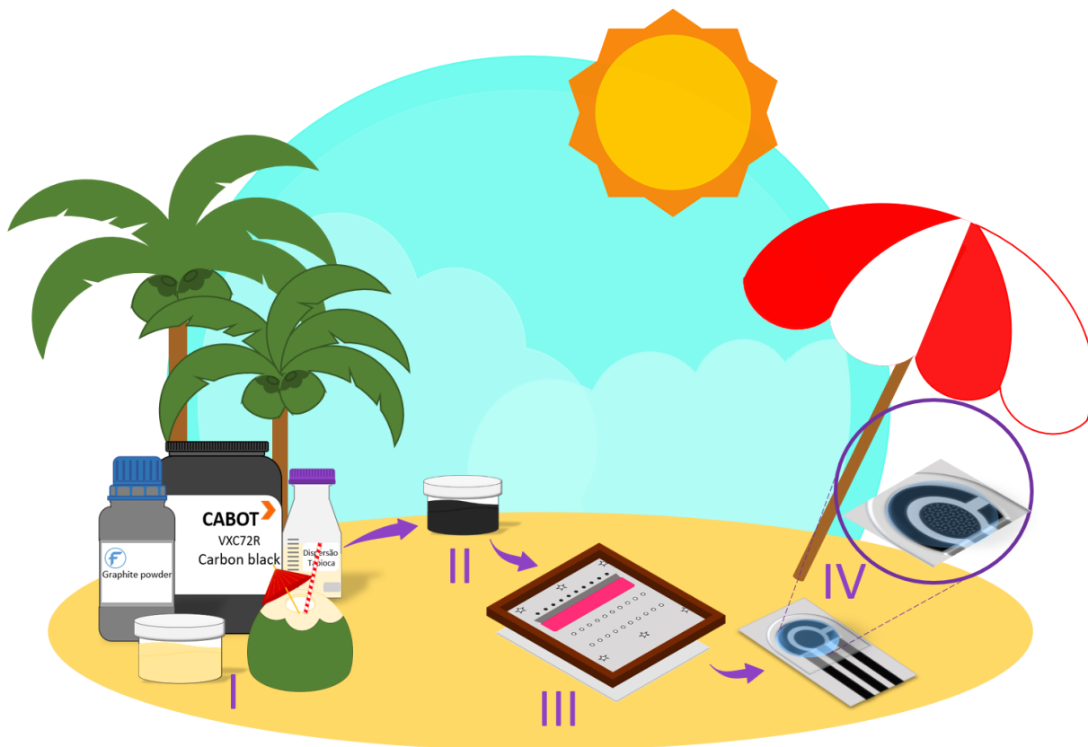
Figura 8. Produção dos biossensores impressos descartáveis. (I) Componentes para preparo da tinta: dispersão tapioca 3% (m/V), com 35% (m/m) de pó de grafite e 10% (m/m) carbon black em relação a massa da dispersão e fibra de coco nas proporções 1 a 5% (m/m). (II) Tinta condutora. (III) Impressão por serigrafia no eletrodo de trabalho. (IV) Medidas eletroquímicas
