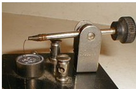
Figura 2.2 – Dispositivo que utilizava o retificador do tipo bigode de gato.
