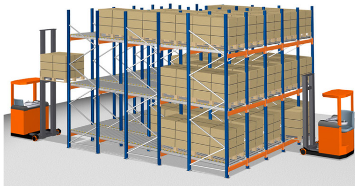
Figura 5 – Representação de um conjunto de prateleiras gravitacionais. Em fábricas de médio e grande porte, prateleiras gravitacionais são adotadas para armazenar os paletes no depósito. Na ilustração, a empilhadeira do lado esquerdo introduz uma caixa-paleta em uma prateleira gravitacional (trilho), que deslizará até encostar nos demais paletes ali alocados, enquanto a empilhadeira do lado direito faz a retirada de um outro paleta requisitado pela linha de produção. Extraído de [81].
