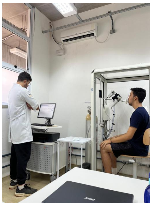
Figura 1 - Pletismógrafo (MasterScreen Jaeger). Imagem feita pelo pesquisador
