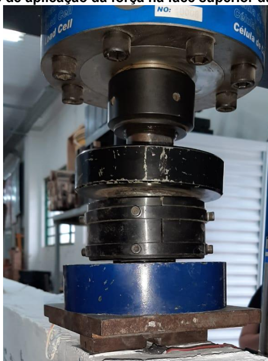
Figura 50: Ponto de aplicação da força na face superior da viga, a meio vão
