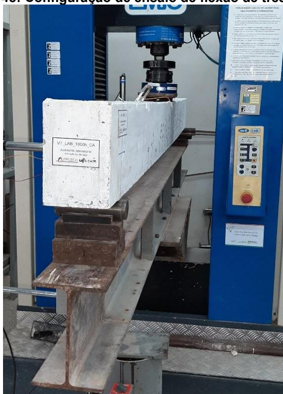
Figura 48: Configuração de ensaio de flexão de três pontos
