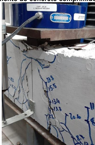
Figura 84: Esmagamento do concreto comprimido – V1_LAB_S_5000h
