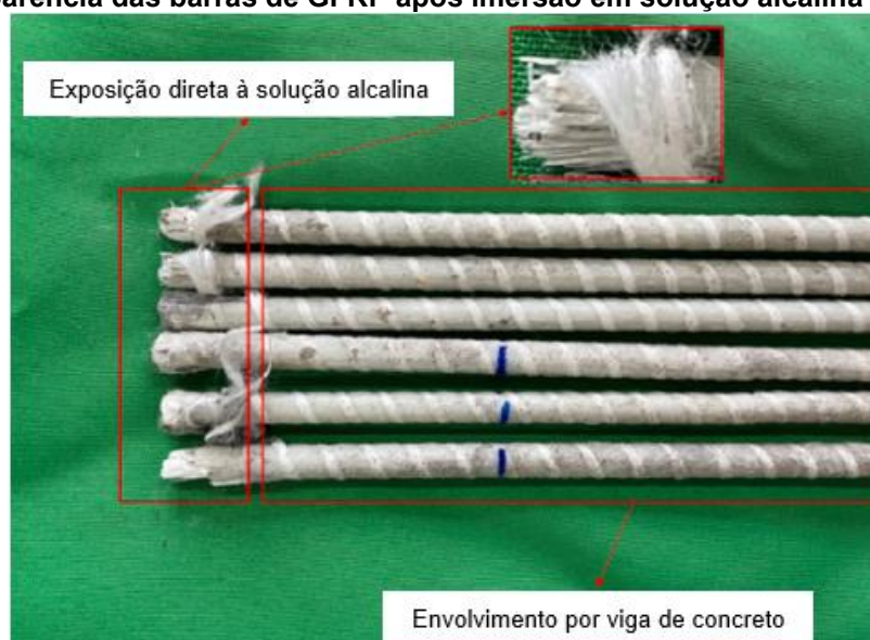
Figura 18: Aparência das barras de GFRP após imersão em solução alcalina durante 8 anos
