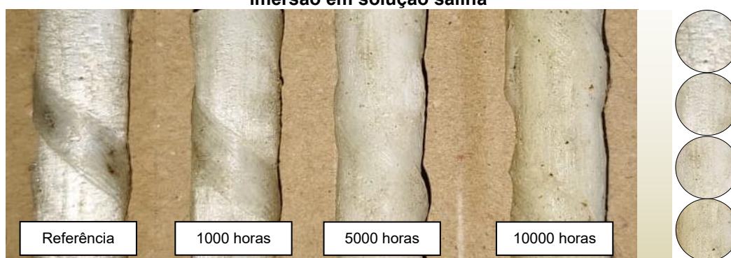
Figura 108: Superfície das amostras desprotegidas antes e após 1000, 5000 e 10000 horas de imersão em solução salina
