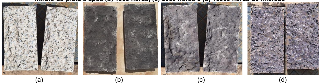
Figura 101: Profundidade de penetração de cloretos: (a) corpos de prova antes da aspersão de nitrato de prata e após (b) 1000 horas, (c) 5000 horas e (d) 10000 horas de imersão
