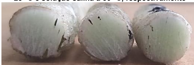
Figura 110: Seção transversal das amostras de GFRP de referência e após imersão em água a 23 °C e solução salina a 50 °C, respectivamente
