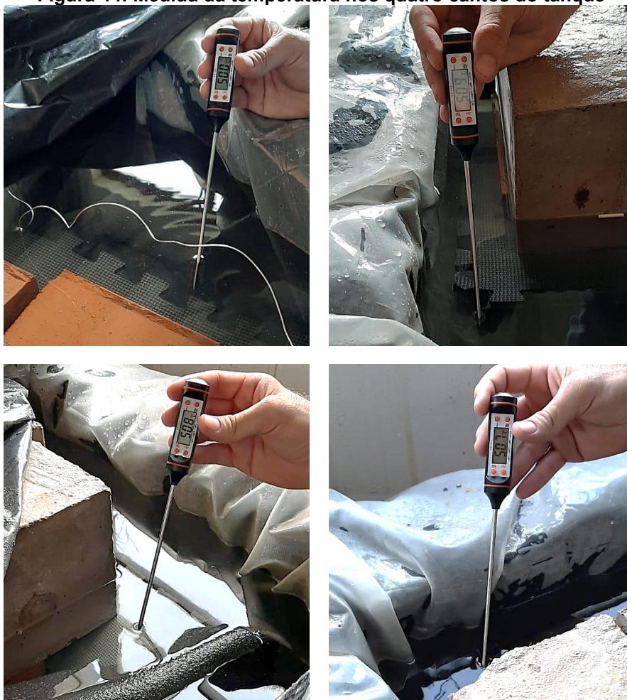
Figura 44: Medida da temperatura nos quatro cantos do tanque
