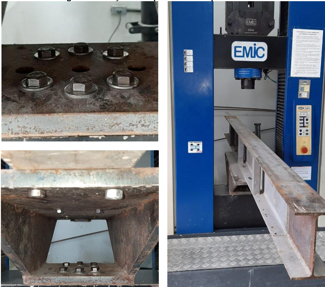
Figura 47: Fixação do dispositivo na máquina de ensaios
