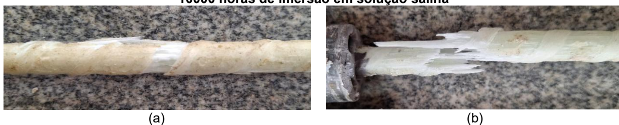
Figura 107: Detalhe da ruptura de uma barra de GFRP (a) desprotegida e (b) protegida após 10000 horas de imersão em solução salina
