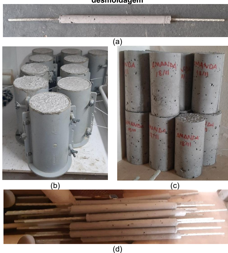
Figura 69: (a-b) Amostras concretadas e (c-d) acondicionadas em ambiente laboratorial após a desmoldagem
