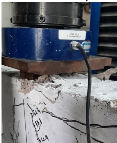
Figura 87: Esmagamento do concreto comprimido – V1_LAB_S_10000h
