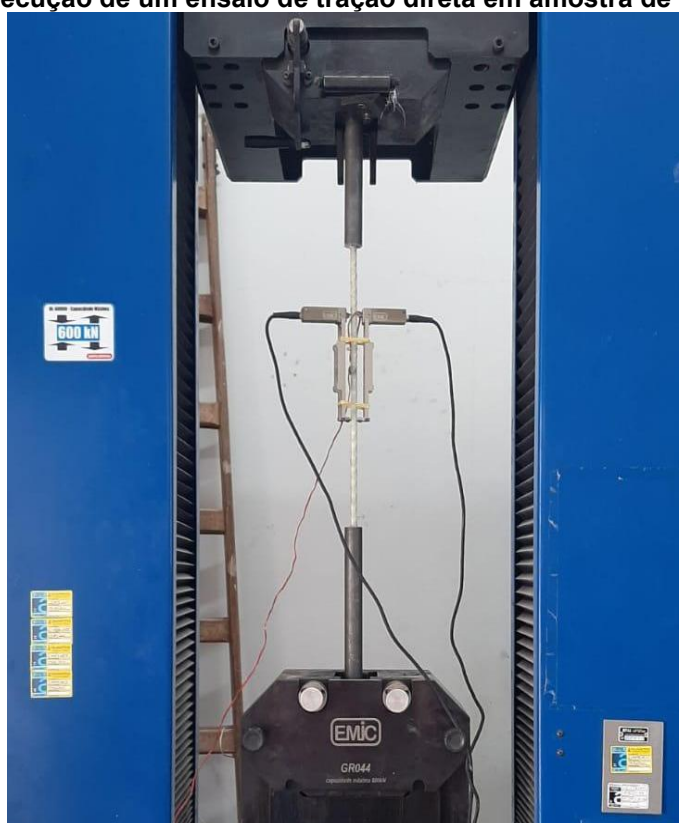
Figura 62: Execução de um ensaio de tração direta em amostra de barra de GFRP
