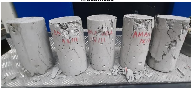
Figura 72: Corpos de prova de concreto após ensaios de caracterização das propriedades mecânicas
