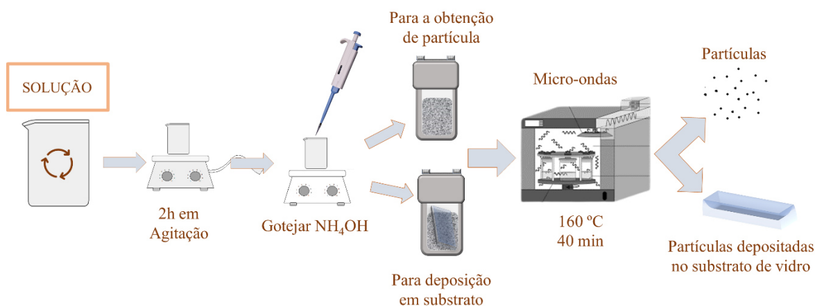
Figura 3.3 – Processo esquemático da síntese hidrotérmica via micro-ondas – Fonte: Próprio autor.
