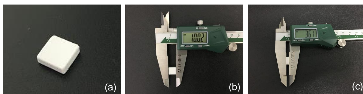
FIGURA 3.5: Amostra de peça impressa de PLGA/ \beta -TCP para tomografia de raios X. (a) Bloco, (b) medida do comprimento do bloco 10,02 mm, e (c) medida da espessura do bloco 3,61 mm.
