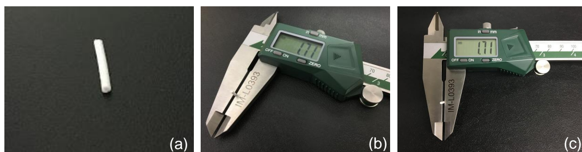
FIGURA 3.4: Amostra de filamento de PLGA/ \beta -TCP para tomografia de raios X. (a) Filamento, (b) e (c) medida do diâmetro do filamento 1,71 mm.
