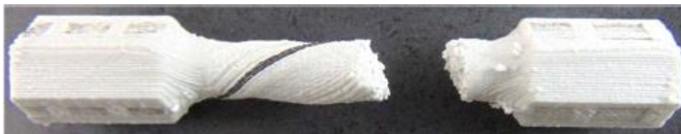
FIGURA 4.30: Corpo de prova de torção logo após finalização do ensaio.
