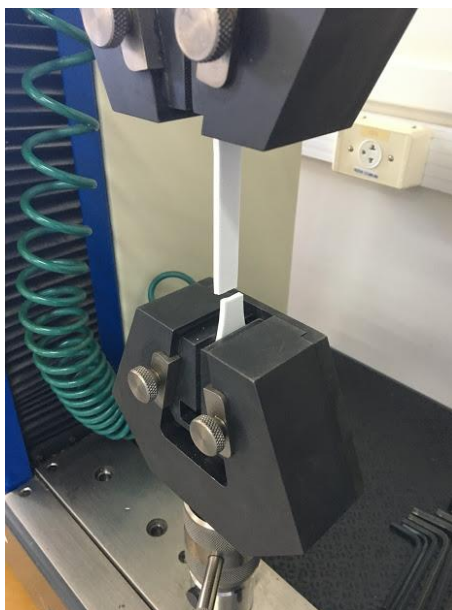
FIGURA 4.26: Corpo de prova de tração logo após finalização do ensaio.
