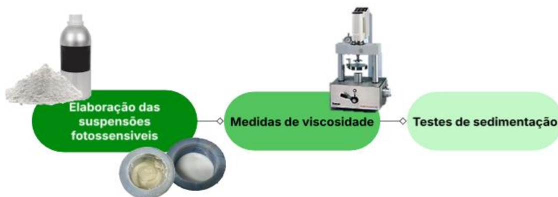
Figura 3.11: Fluxograma da Etapa II: Incorporação do pó de Biosilicato na resina fotocurável
