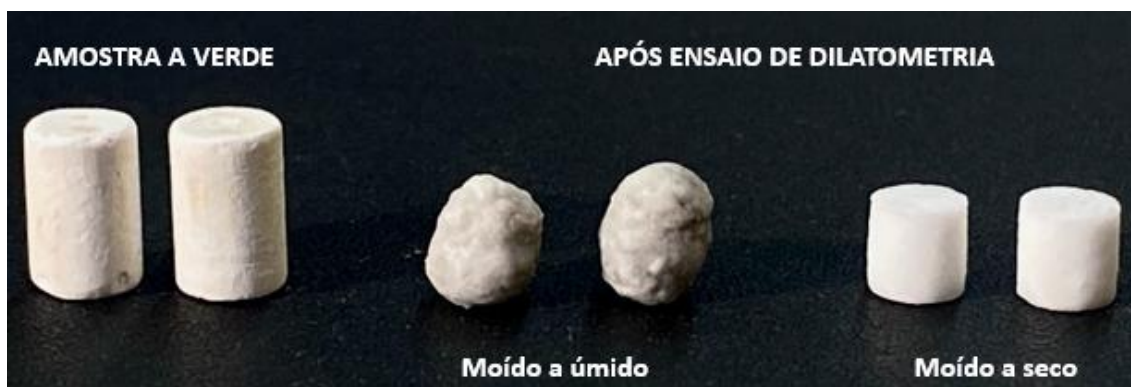
Figura 2.13: Comparação entre as amostras queimadas no ensaio de dilatometria após diferentes rotas de moagem.
