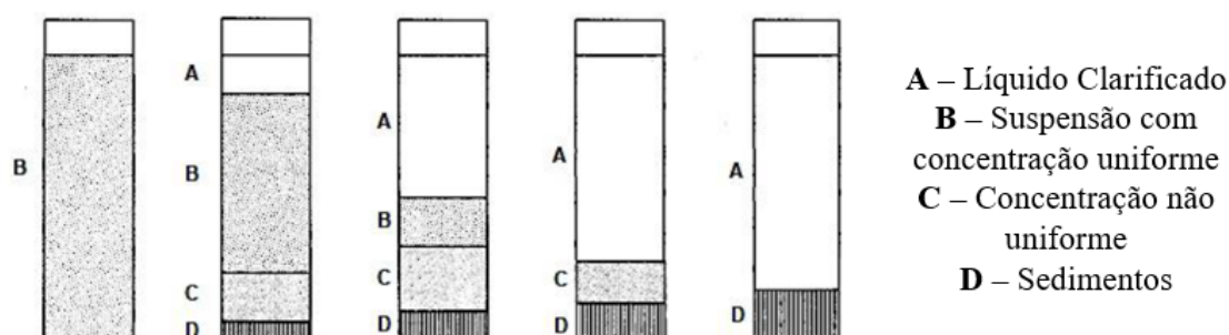
Figura 3.12: Etapas do ensaio de sedimentação com a utilização de proveta. Fonte: Adaptado FOUST et al.
