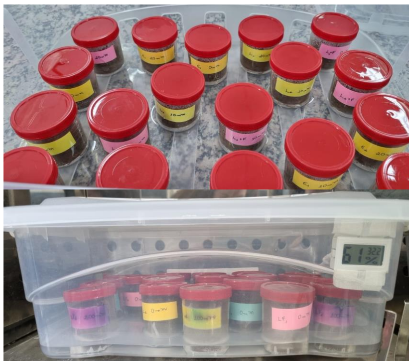
Figura 5. Disposição dos pequenos potes contendo solo dentro de uma caixa do tipo organizadora para manter a umidade, acondicionados em incubadora.
