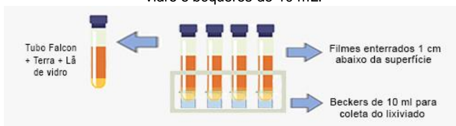
Figura 17. Sistemas de lixiviação, montados com tubos Falcon, terra orgânica, lã de vidro e béqueres de 10 mL.
