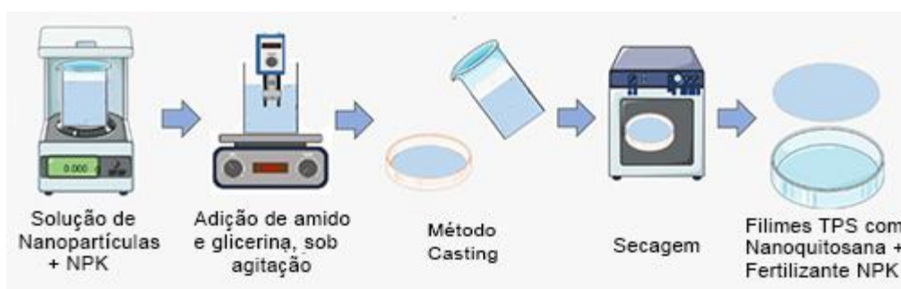
Figura 16. Metodologia Casting para produção dos filmes TPSNQ com as nanopartículas de quitosana previamente carregadas com nutrientes NPK.
