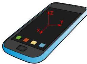
Figura 7 – Orientação dos eixos de um smartphone
