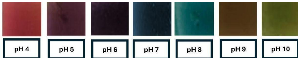
Figura 15- Resposta colorimétrica das membranas de COL/ERR/VAN em diferentes pHs (4 a 10).
