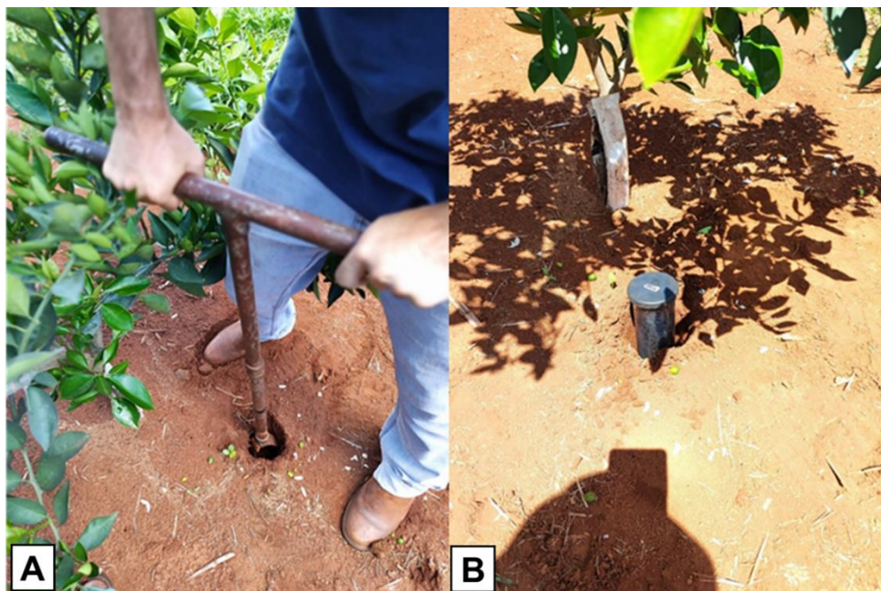
Figura 5. (A) Abertura do buraco para instalação do minirrizotron, (B) Tubo instalado.
