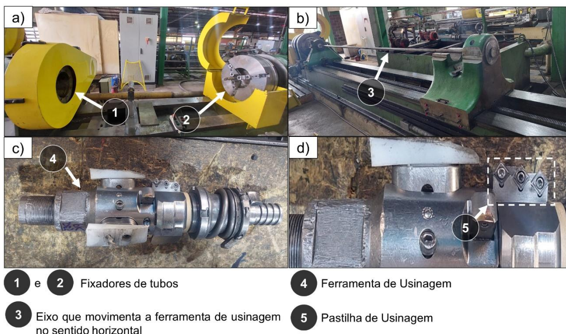
Figura 2.8 – Equipamento de usinagem empregado no acabamento superficial do diâmetro interno dos tubos centrifugados. (a) Locais de fixação dos tubos. (b) Eixo que movimenta a (c) ferramenta de usinagem e as (d) pastilhas empregadas na remoção de material. Cortesia da ENGENMASA Engenharia e Materiais LTDA.
