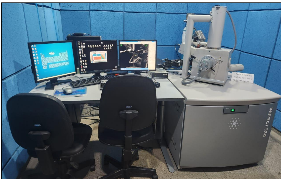
Figura 3.12 – Microscópio Eletrônico de Varredura FEI Inspect S50 equipado com analisador EDS do Laboratório de Caracterização de Estrutural (LCE).
