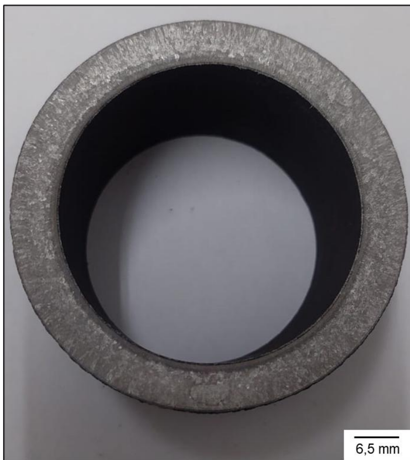
Figura 4.7 – Macroestrutura do segmento de tubo carburizado utilizado nas amostras C, B-C e C-C.
