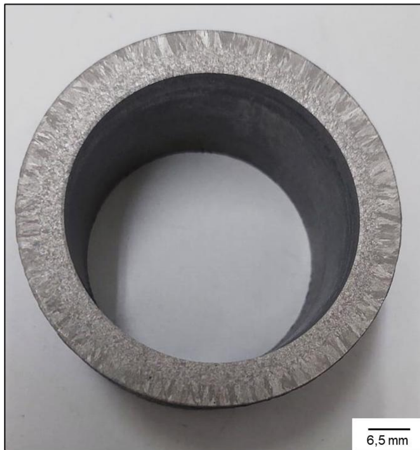
Figura 4.6 - Macroestrutura do segmento de tubo bruto utilizado na amostra B-B.
