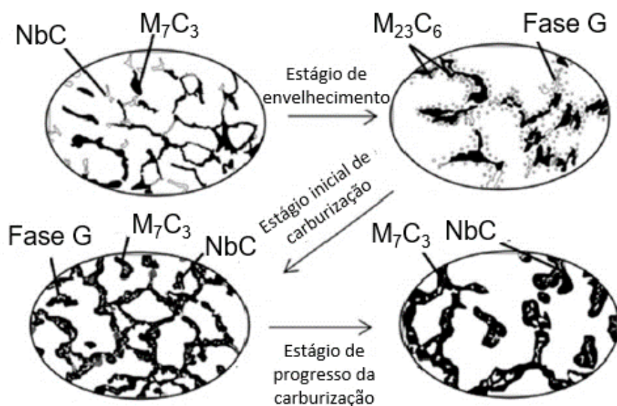
Figura 2.19 - Hipótese da evolução da microestrutura dos tubos de pirólise de 35Cr45NiNb em serviço. Adaptado de [20].
