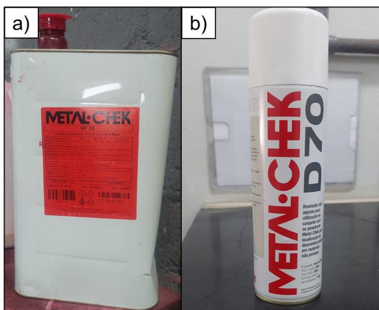
Figura 3.6 – (a) Líquido Penetrante Metal-Check VP30 e (b) Revelador Metal-Check D70.
