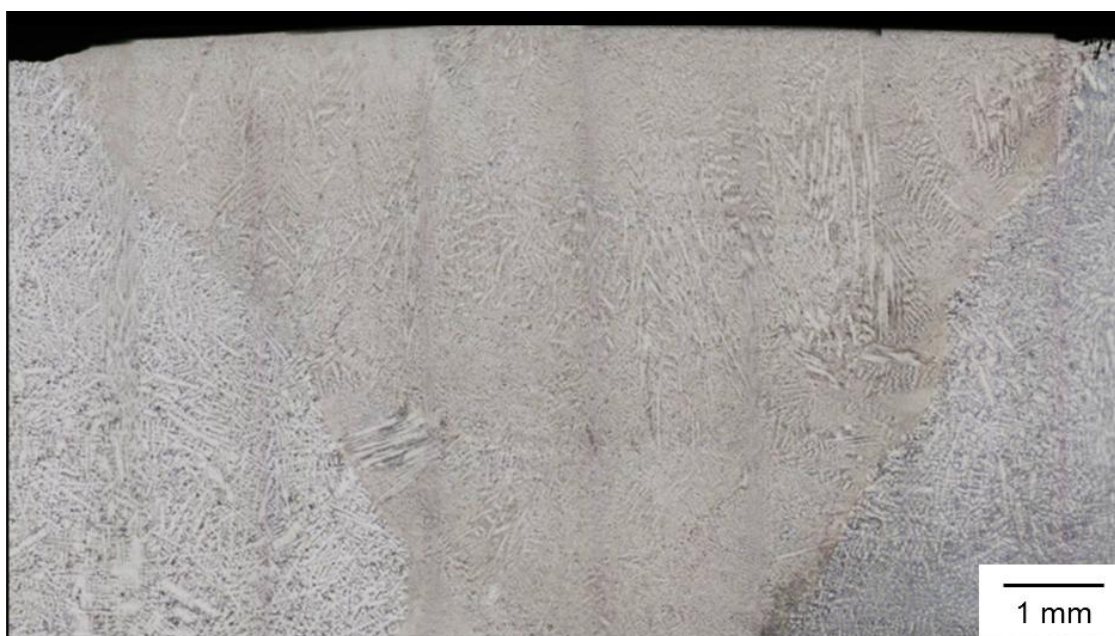
Figura 4.9 – MO da junta soldada B-C.
