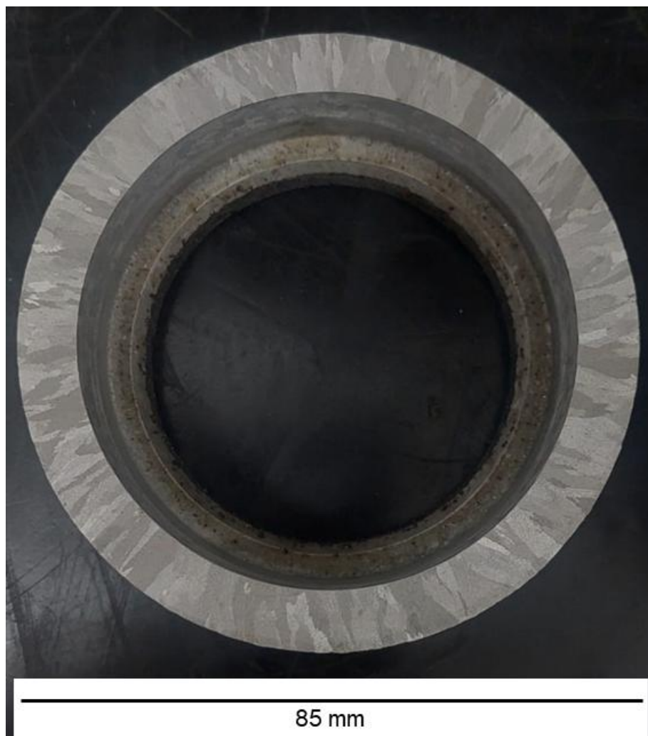
Figura 2.10 – Macroestrutura de um tubo centrifugado de 35Cr-45NiNb com grãos 100% colunares. Cortesia da ENGEMASA Engenharia e Materiais LTDA.
