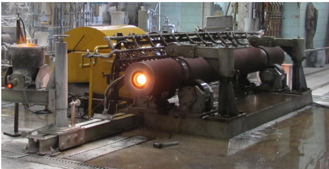
Figura 2.7 – Equipamento de fundição centrífuga horizontal real durante a centrifugação de um tubo. Cortesia da ENGEMASA Engenharia e Materiais LTDA.
