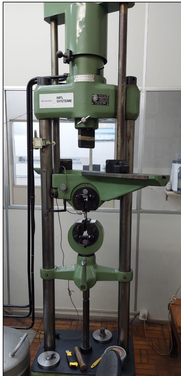
Figura 3.8 - Equipamento de ensaio universal Mohr-Federhaff-Losenhausen, modelo D6800, do laboratório da ENGEMASA Engenharia e Materiais LTDA.
