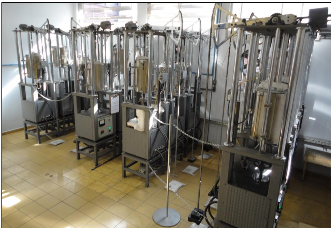
Figura 3.10 - Equipamentos de ensaio de ruptura por fluência do laboratório da ENGEMASA Engenharia e Materiais LTDA.
