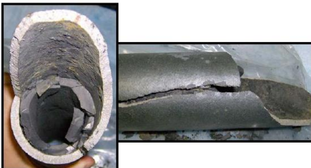
Figura 2.16 – Tubo de pirólise contendo coque aderido em sua superfície interna que trincou devido ao resfriamento brusco do forno causado por uma queda de energia [5].
