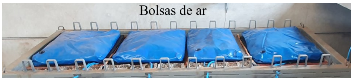
Figura 3.27: Posicionamento bolsas de ar no topo dos modelos físicos.
