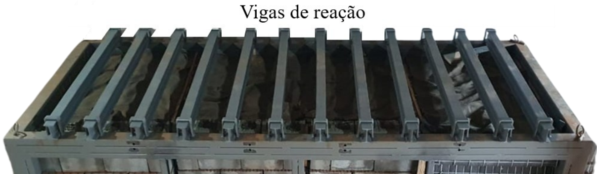
Figura 3.4: Vigas de reação na parte superior da caixa de ensaios.
