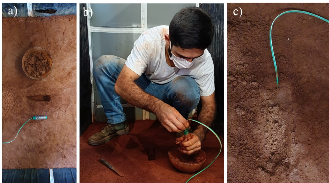
Figura 3.36: Instalação tensiômetro: a) Abertura solo e preparo lama; b) Cobertura tensiômetro; c) Posicionamento e cobrimento.
