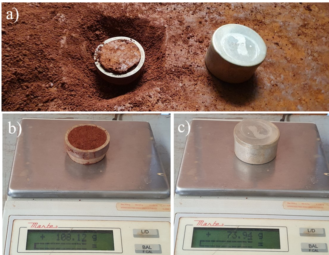
Figura 3.11: a) Retirada amostra indeformada e coleta do solo para a determinação teor de umidade; b) Pesagem amostra indeformada no anel de talhagem; c) Pesagem cápsula com solo úmido.
