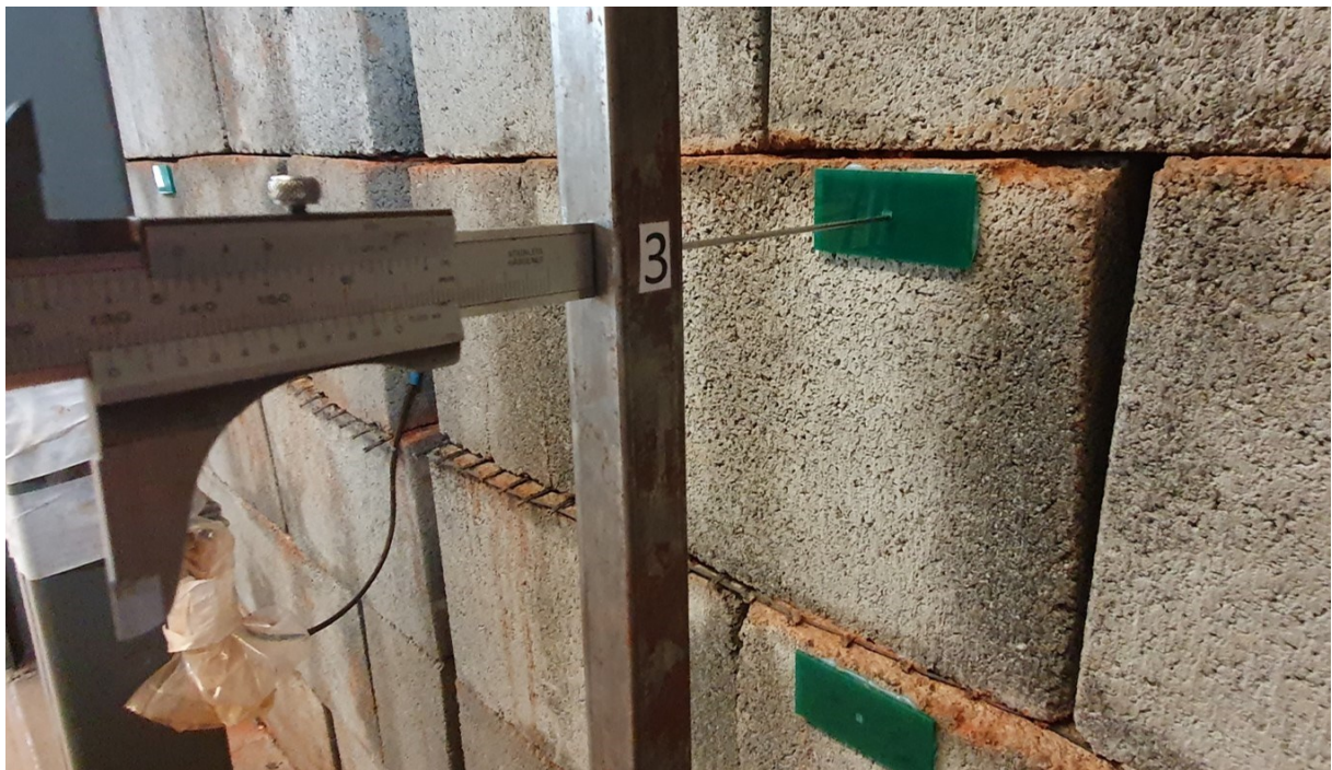
Figura 3.43: Medição deslocamento horizontal da face.
