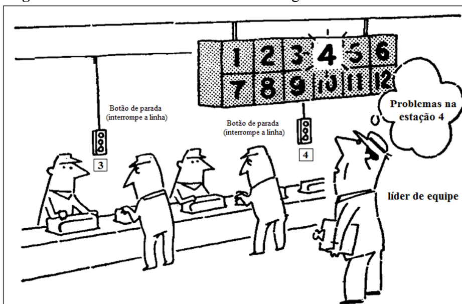
Figura 1 O Sistema Andon - linha de montagem manual
