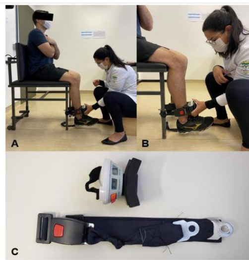
Figura 2 - Mensuração da força muscular do quadríceps (A e B) utilizando dinamômetro portátil MicroFet 2 (C). Nota: fotos A e B com finalidade meramente ilustrativa, não envolvendo pacientes do estudo. (Fonte: arquivo pessoal).
