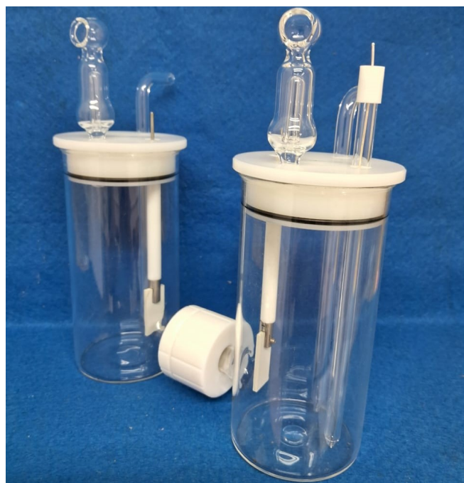
Figura 4.3: Célula eletroquímica em H, de vidro, para uso com membrana.
