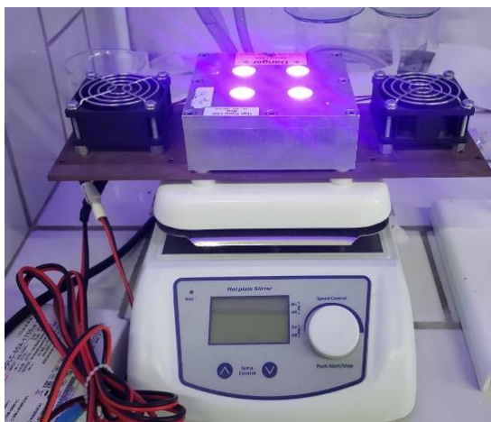
Figura 12: Imagem do fotoreator utilizado para as reações de redução fotocatalítica do nitrobenzeno.
