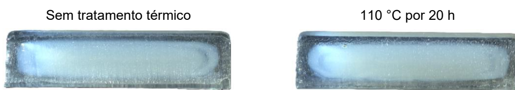
Figura 4.23: Seção transversal de corpos de prova moldados por injeção, demonstrando a camada congelada de TPU, formada quando o polímero fundido entrou em contato com o molde a 50 °C. Não foram observadas diferenças significativas na espessura dessa camada após o tratamento térmico pós-moldagem (110 °C por 20 h). Dimensões aproximadas da seção transversal: 13 mm × 3,2 mm.
