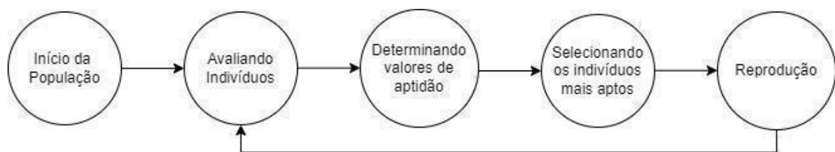
Figura 9. Processo geral de algoritmos evolutivos. Adaptado de (27).
