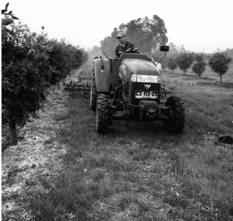
Fotografia 29. Os subsoladores são utilizados para melhorar a aeração do solo e, assim, permitir que as trufas respirem e cresçam mais uniformes. ATChile, 2023.
