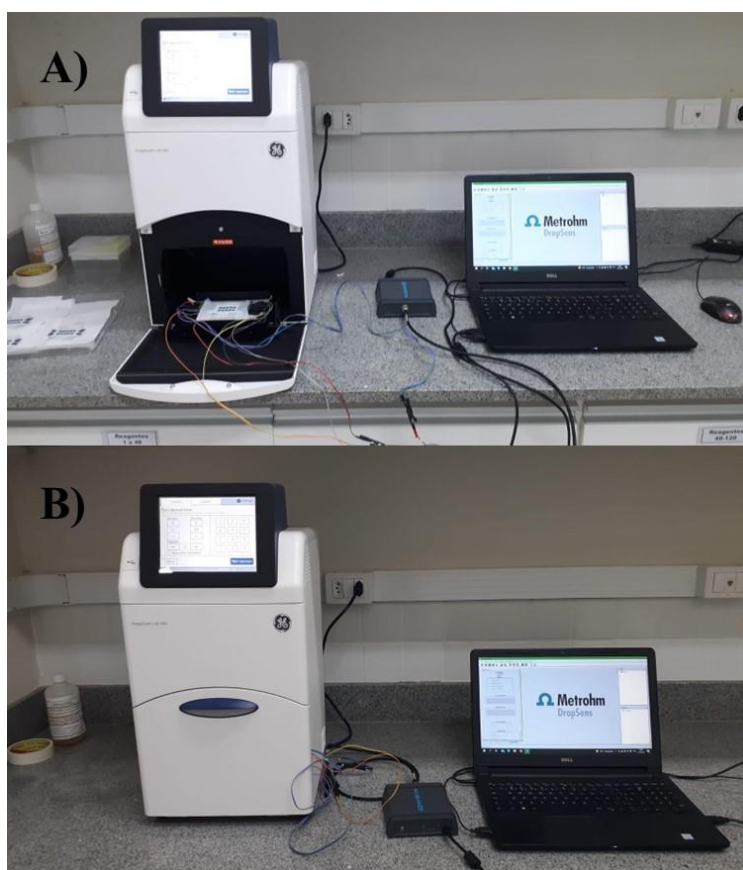
FIGURA 4.1 A) Sistema para detecção da ECL B) Sistema para detecção da ECL, compartimento do fotodocumentador fechado para captura de imagens.
