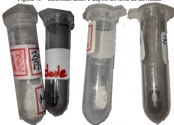
Figura 43 – Zircônias antes e depois do teste de atividade
