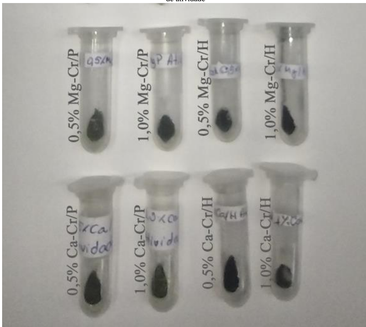
Figura 92 – Catalisadores de cromo suportados em zircônias monoclinicas promovidos com MAT após a reação de atividade
