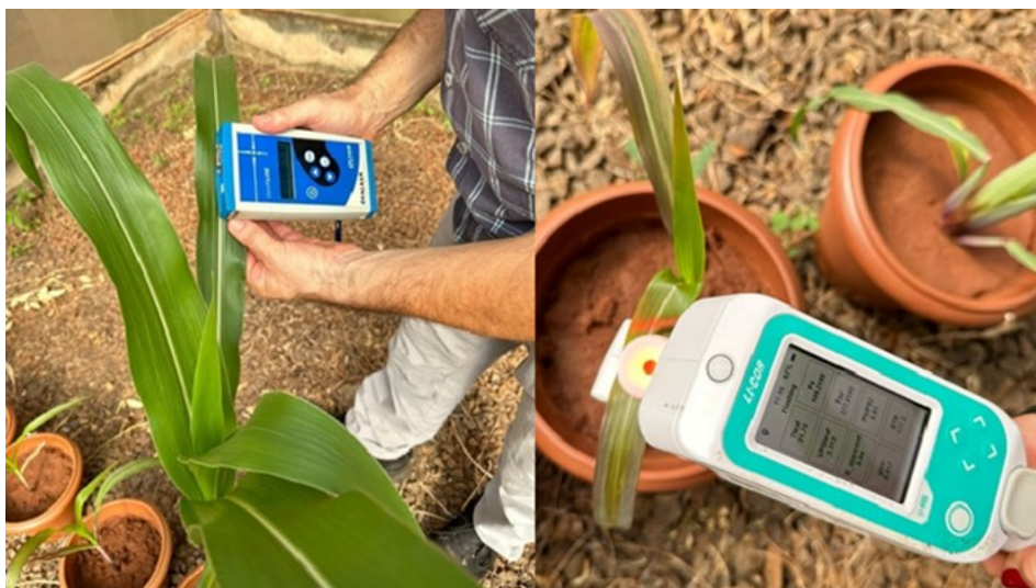
Figura 9. Medição do teor de clorofila a e b e das variáveis da fotossíntese
