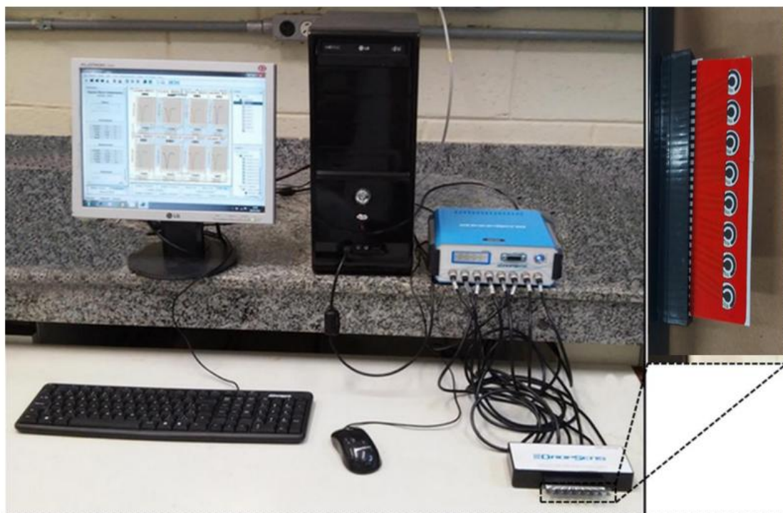
FIGURA 3.9 - Foto do sistema eletroquímico utilizado para a detecção de quitina utilizando o SED.
