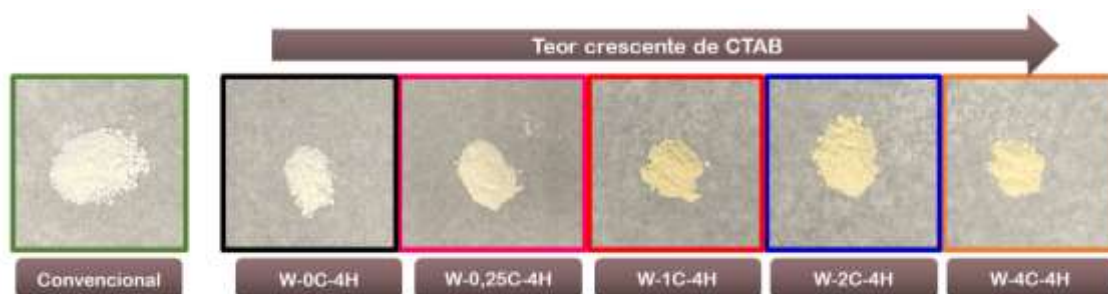
Figura 52: Imagens dos pós resultantes das sínteses de ZIF-8 com diferentes teores de CTAB.
