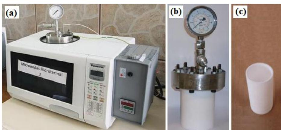
FIGURA 3.1: Fotografia do sistema hidrotérmico de aquecimento por micro-ondas. (a) Sistema em funcionamento, (b) célula reacional e (c) copo reacional de teflon (adaptado de [2]).
