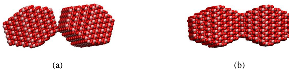
FIGURA 4.8 – Representação das estruturas inicial (a) e final (b) de uma Dinâmica Molecular no ensemble NVT (300 K) de um dímero de nanopartículas de anatase, partindo-se da estrutura de menor energia em r = 39,8 \text{ \AA} , a qual representa uma interação entre dois vértices.
